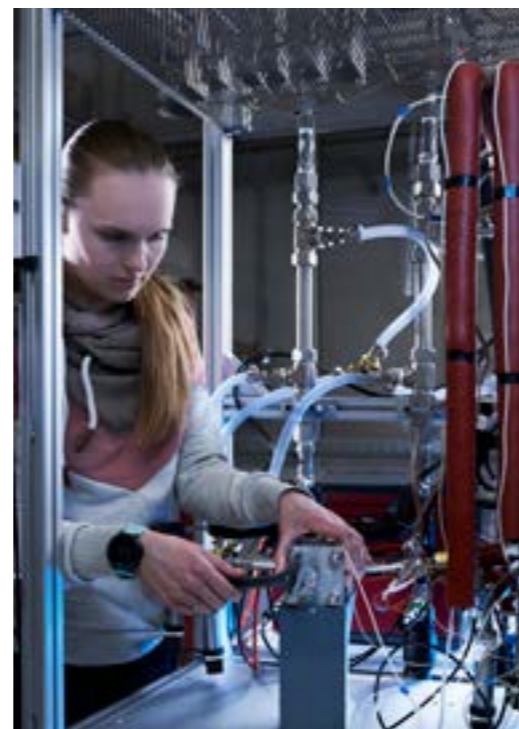
Charakterisierung einer PEM-Elektrolysezelle unter hohen Drücken. Foto: IAM-ET/KIT
