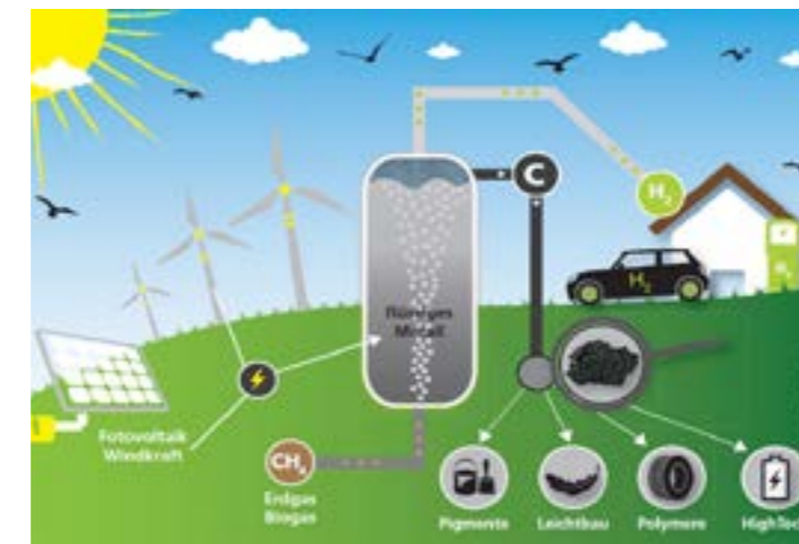
In einem Blasensäulenreaktor mit heißem Zinn wird Methan in gasförmigen Wasserstoff und festen Kohlenstoff gespalten. Grafik: Leon Kühner/KIT
