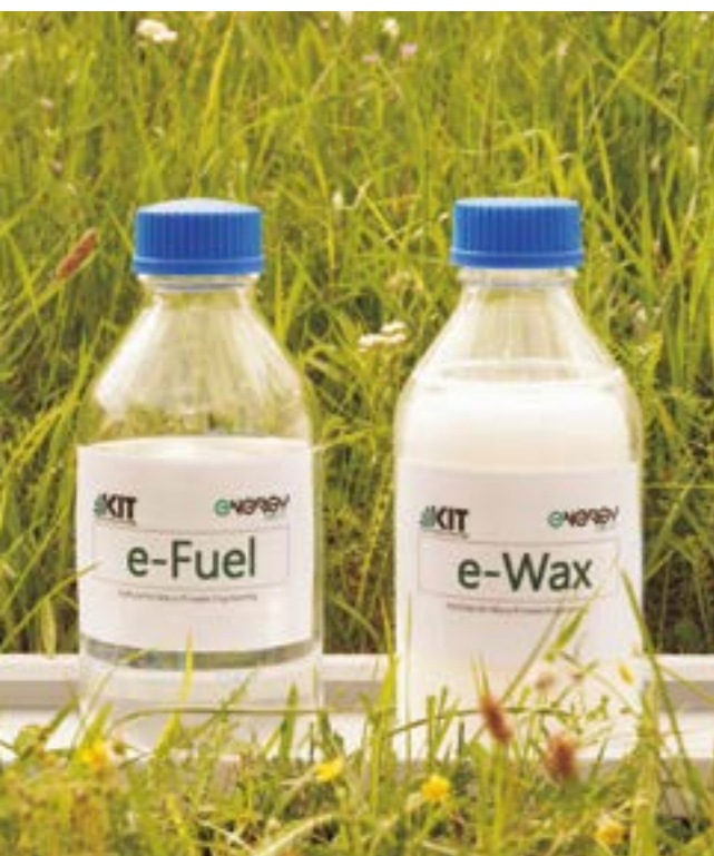
Synthetischer Kraftstoff aus Wasserstoff und Kohlendioxid. Foto: IMVT/KIT
